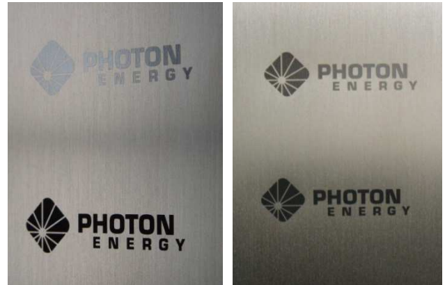
Abb. 4 Edelstahl beschriftet mit ns-Laser (jeweils oben) und ps-Laser (jeweils unten) aufgenommen von der Seite (links) und senkrecht von oben (rechts)
